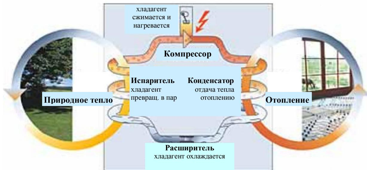
В качестве низкопотенциального источника тепловой энергии для обогрева дома может быть использовано тепло естественного происхождения (наружный воздух; тепло грунтовых, артезианских и термальных вод; воды рек, озер, морей и других незамерзающих природных водоемов). Тепловые насосы комплектуется системой управления и автоматики, которая поддерживает заданный режим работы теплового насоса.
