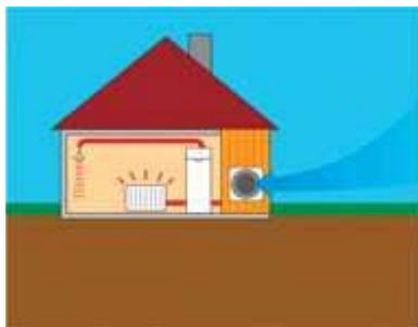
Вместо того, чтобы извлекать энергию из скважин, земли или водоема теплонасосная установка собирает энергию из окружающего воздуха. Если нет возможности разместить земляной коллектор, данная модель теплонасосной установки является наилучшим выбором. Теплонасосные установки дают тепло и горячую воду в дом и сокращает потребление энергии до 75%.
