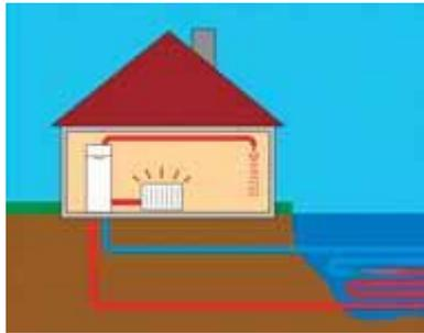
При использовании в качестве источника тепла воды ближайшего водоема, реки контур укладывается на дно. Этот вариант является идеальным с любой точки зрения: короткий внешний контур, «высокая» температура окружающей среды (температура воды в водоеме зимой всегда положительная), высокий коэффициент преобразования энергии тепловым насосом. Главное условие - водоем должен быть проточным и достаточным по размерам.
